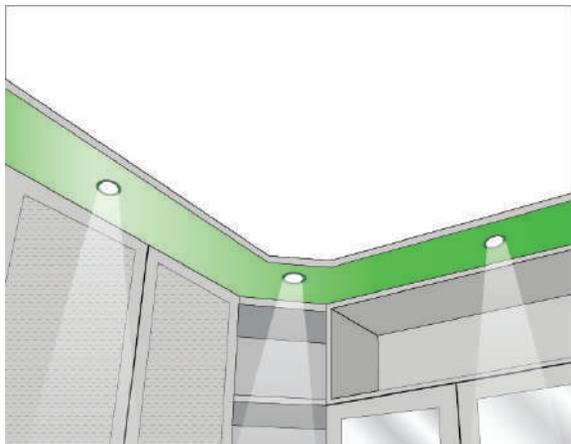
Для реализации такой подсветки используют точечные источники с направленным или рассеянным пучком света, размещенные на козырьках мебели (галогенные или светодиодные лампочки). Такой вариант размещения улучшает освещенность пространства перед мебелью и ее содержимого.
