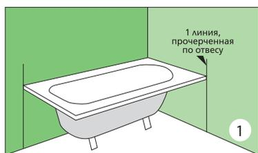
1 С помощью отвеса прочертите на стене вертикальную линию, касающуюся угла ванной.
