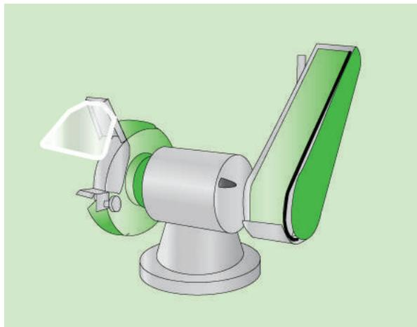
Универсальное электрическое точило предназначено для заточки и доводки основных режущих и колющих инструментов, например, кухонных ножей, фрез, сверел, стамесок и т.д., выполненных из инструментальной стали и твердых сплавов. Вал электрического двигателя имеет расположенные на противоположных концах посадочные шейки для установки абразивных или шлифовальных дисков. Грубый диск с крупнозернистым абразивом используют для предварительной обработки, а мелкозернистый – для доводки.
