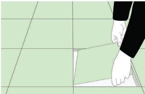
После высыхания стяжки можно приступать к укладке плитки на плиточный клей, выравнивая по строительному уровню монтируемые плитки.
