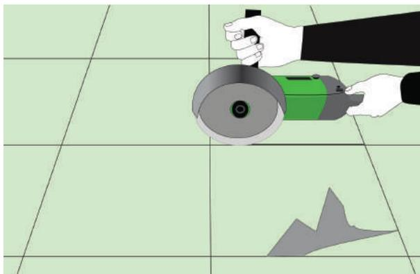
Для штучной замены необходимо аккуратно удалить дефектную плитку, не задев окружающие. Можно прорезать швы вокруг дефектной плитки с помощью болгарки.
