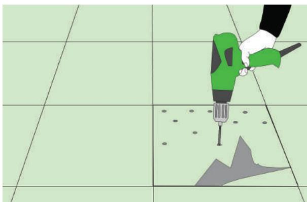
Саму дефектную плитку удаляют либо фрагментами (предварительно засверлив ее), либо раскалывая долотом на части.
