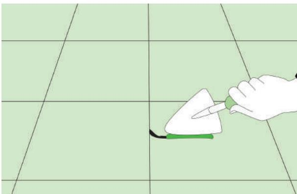
Мелкие трещины можно тщательно зашпаклевать тестообразной смесью мелкого песка и цемента с помощью шпателя или тампона. По высыхании остатки смеси счищаются ветошью. Затирку швов следует проводить только после полного высыхания клея (по инструкции производителя). Избыток снимается губкой в несколько приемов.
