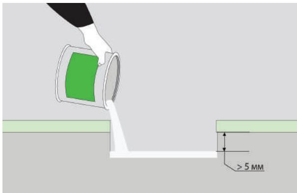
В образовавшуюся выемку заливают новую стяжку. Разница между уровнем новой стяжки в выемке и уровнем стяжки основного пола должна составлять не менее 5 мм.
