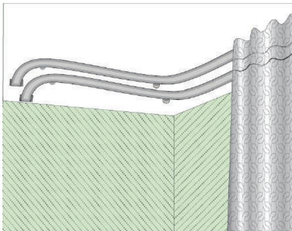
Для эркера можно использовать отрезки описанных ранее карнизов или гибкий пластиковый карниз ленточного типа. При расчете длины карниза для эркерного окна важно учесть не только размеры отдельных секций, но и углы их примыканий, а также особенности конструкции самого эркера.
