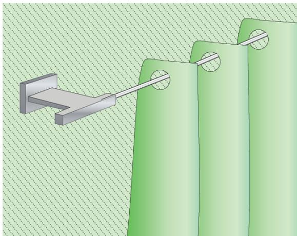
В струнных карнизах направляющей служит трос или проволока, закрепленные в концевых опорах, что обеспечивает малозаметность конструкции. Однако такой карниз не подходит для тяжелых штор из плотной ткани.
