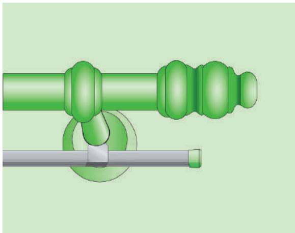
Направляющая круглого карниза — труба определенного диаметра (1–3 см) — крепится на стену с помощью кронштейнов и снабжена по концам декоративными заглушками-шишками. При производстве используют металл, дерево, пластик. Для расширения функционала такой карниз может комплектоваться дополнительной направляющей для размещения более легкой ткани.
