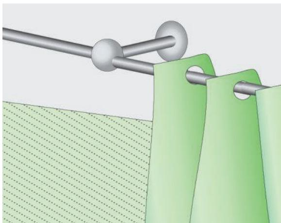
Кронштейны крепления карниза к стене должны обеспечить надежное крепление карниза, на котором висит тяжелая ткань. Длина кронштейна от стены в комнату должна обеспечить свисание шторы за выступом подоконника. Общее количество кронштейнов в расчете на один карниз должно составлять не менее трех кронштейнов на 2,5 м длины карниза.
