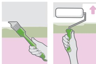
1. Начинайте покраску потолка с обработки углов и стыков со стеной. Используйте для этого специальную кисть.
