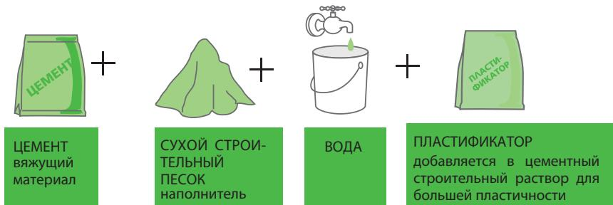
Дозировка строительного раствора в расчете на один мешок цемента
