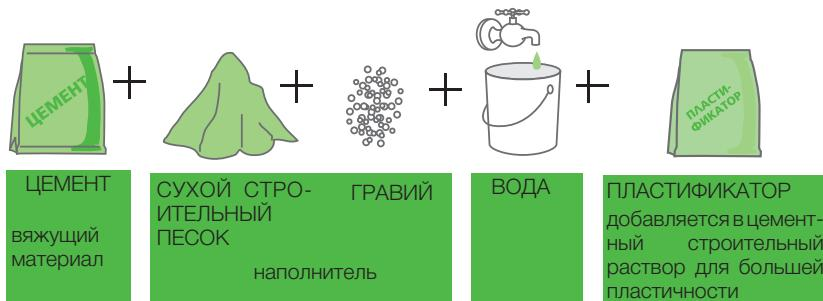
Бетон служит для разнообразных строительных работ (фундамент, стяжка, балки, перекрытия). Для увеличения прочности бетона в него помещают стальную арматуру, в результате чего получают железобетон. Окисление металлической поверхности упрощает связывание бетона с арматурой.
