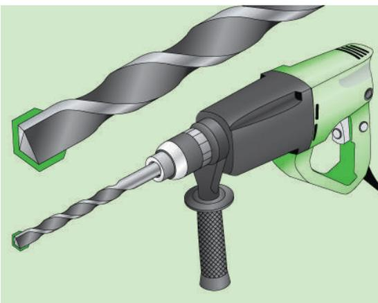
Бур в отличие от сверла может иметь головку с несколькими режущими кромками разной формы. По конфигурации заточки буры бывают классические (пластина имеет крест-накрест ровные режущие плоские передние и задние грани) и центрирующие (пластина имеет геометрию, исключающую увод бура внутри отверстия от оси начального положения).
