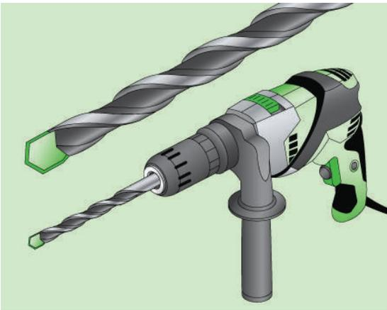
Для сверления кирпича, керамики, бетона применяют сверла с твердосплавной вставкой и цилиндрическим хвостовиком.
