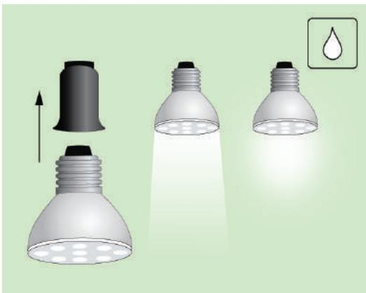
Кроме того, эти лампы просты в применении (их вкручивают в обычные патроны) и могут эксплуатироваться в условиях высокой влажности.
